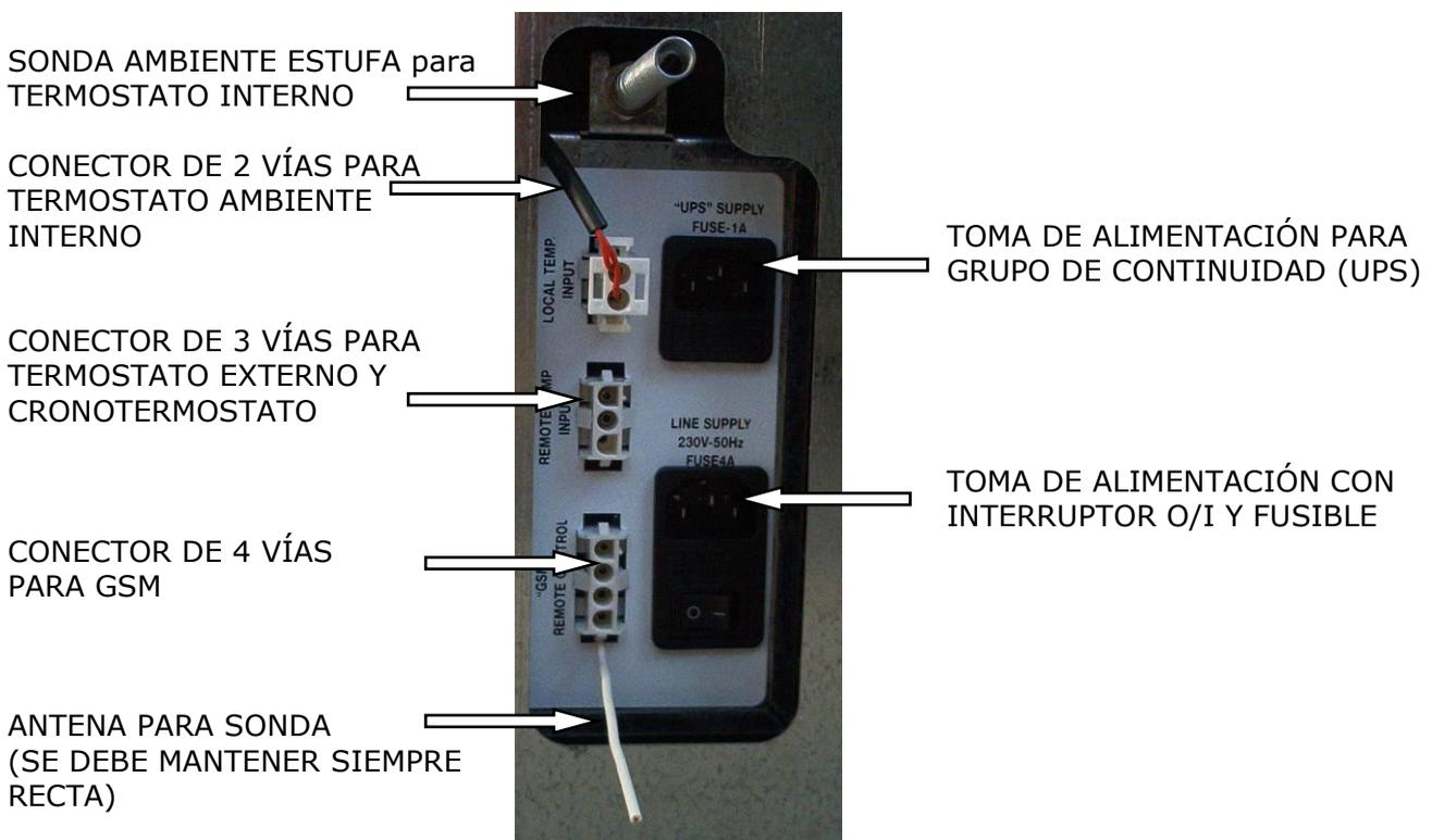
Para el funcionamiento del termostato externo y del cronotermostato, quitar el conector de 2 vías del termostato ambiente e introducir el conector de 3 vías.
