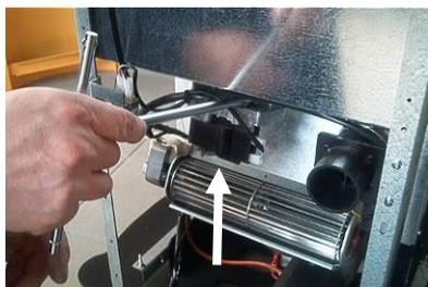
Si el motorreductor no empuja el pellet, a pesar de que el motor gire, quiere decir que se han dañado algunos engranajes. Para proceder a la sustitución, aflojar el tornillo que los fijan al perno.
