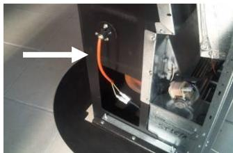
Para sustituir la bujía, destornillar el tornillo de fijación y quitarla de su asiento.
