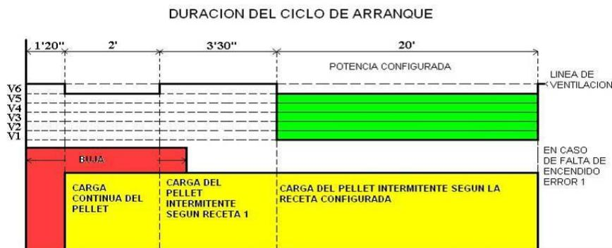
**ATENCIÓN:** la fase de arranque dura **1 CICLO** de 07 minutos. Transcurrido este tiempo, en el display se visualiza el mensaje **Estufa Encendida, la modalidad Automática o Manual, la hora y la fecha**, y será posible regular la combustión. Normalmente el encendido ocurre después de 3 minutos.
