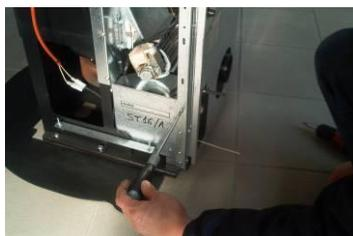
Para sustituir la caja que contiene los dispositivos electrónicos, quitar los 3 tornillos que la mantienen fijada al montante, sacar la tapa y los conectores de su asiento.
