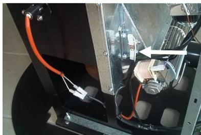
Si el termostato de control del ventilador de reciclaje no interviene cuando la temperatura de la estufa llega a 70° centígrados, sustituir el termostato y, si el problema continúa, sustituir los dispositivos electrónicos (véase sustitución de los dispositivos electrónicos).
