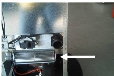
Para sustituir el ventilador de reciclaje, sacar los 4 tornillos que lo mantienen fijo.
