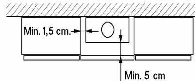
2) los amoblamientos deben terminar lateralmente a 1,5 cm. del calefón para poder retirar con comodidad el gabinete para su mantenimiento y mantener una ligera ventilación que evite el calentamiento del mismo.
