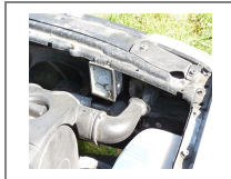
Amperímetro colocado en la parte delantera del motor
