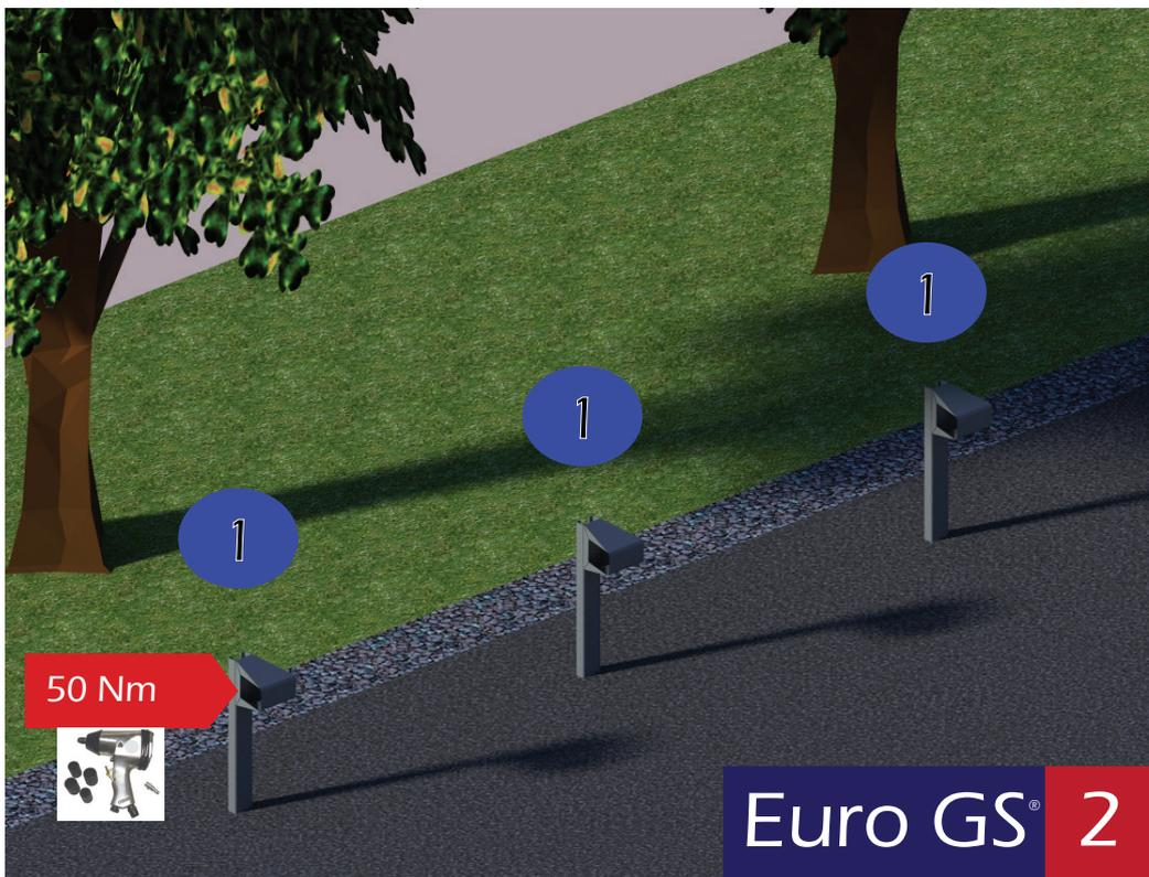
Los separadores se unen al poste con un tornillo de cabeza hexagonal TH 16x40 con una tuerca M16-32.
