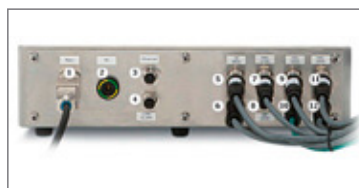
Figura 2-6: Suministro de señales y alimentación de la unidad de filtración
