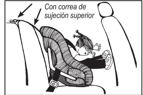
B. En un choque fuerte el cinturón de seguridad, la correa de sujeción, y el arnés trabajan juntos para mantener la cabeza del niño fuera de peligro.
