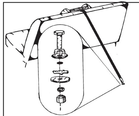
*E. Instalación de un juego de anclaje para una correa de sujeción en el área de carga de una camioneta familiar (station wagon)*
