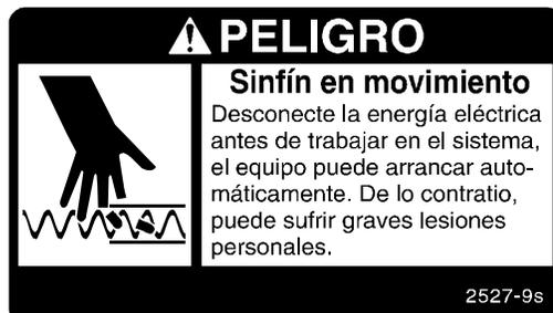
En preparación para la instalación del sinfín, efectuar lo siguiente:
