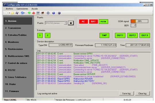
"Monitoreo de dispositivo" proporciona información en tiempo real sobre el estado del dispositivo. Para usar esta función, el dispositivo debe estar conectado a un computador PC con un cable de LX-Data (usando enchufe DEBUG). El puerto RS232 debe ser seleccionado en el campo "Puerto". "Control de dispositivo" proporcionará la siguiente información:
