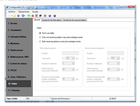
Determina la manera de funcionamiento de Dialer (linea convencional) del LX20G. Es posible apagar la comunicación por RTB (Dialer) o configurarlo de tal forma que funcione con una o Dos CRA. La manera de contactar con CRA puede ser configurada a través de los parametros siguientes, tanto para la CRA1 como para CRA2:
