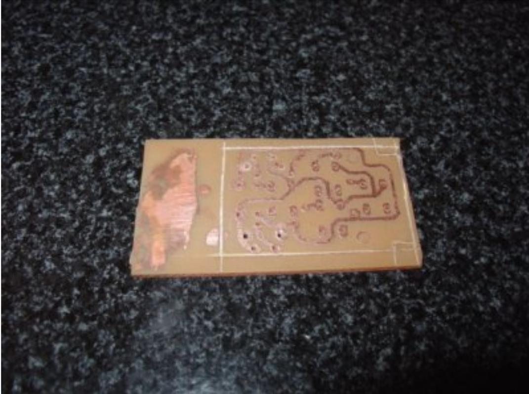
8) Recortar la plaqueta a la medida necesaria y lijar los bordes hasta que encaje perfectamente en la carcasa.
