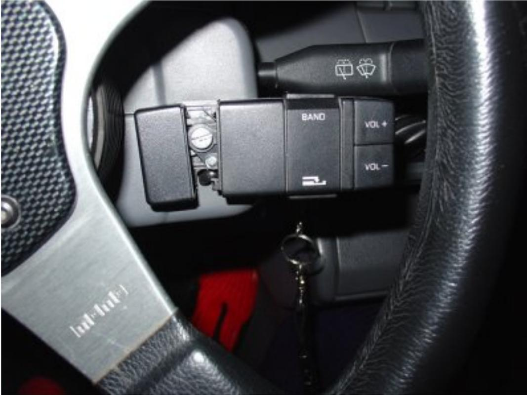
2) Sacar los tres tornillos de la tapa debajo del volante con el destornillador torx.
