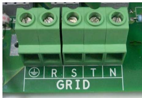
Fig.11 Tablero de bornes para conexiones cables AC
