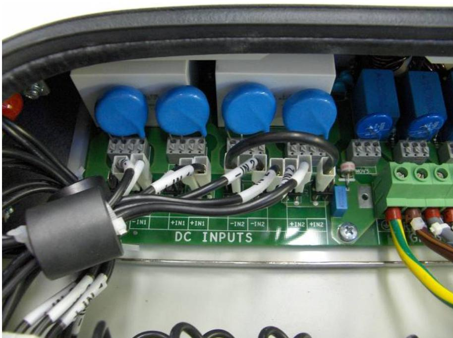
Fig.13 Conexiones necesarias para ejecutar el cortocircuito en el canal 2
