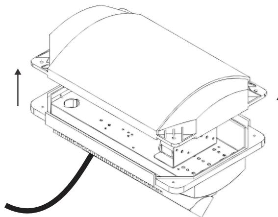
4. Desatornillar y desasegurar el porta equipo del cuerpo del aplique.
