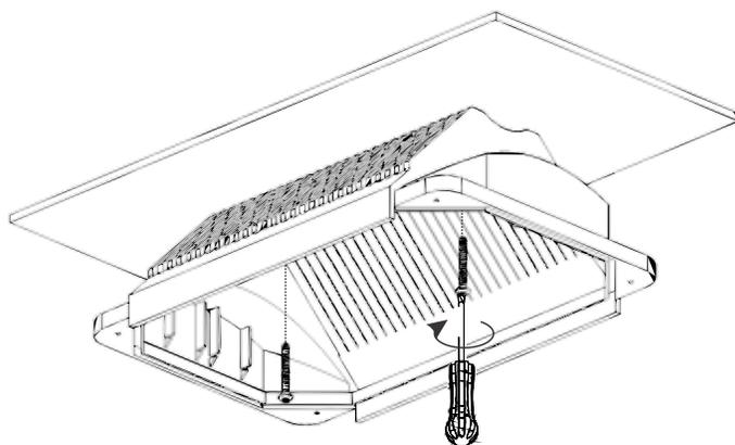
10. Ensamblar el porta equipo en el cuerpo del aplique ya instalado.
