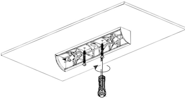
19. Ensamblar el cuerpo del aplique con la tapa instalada en la superficie.
