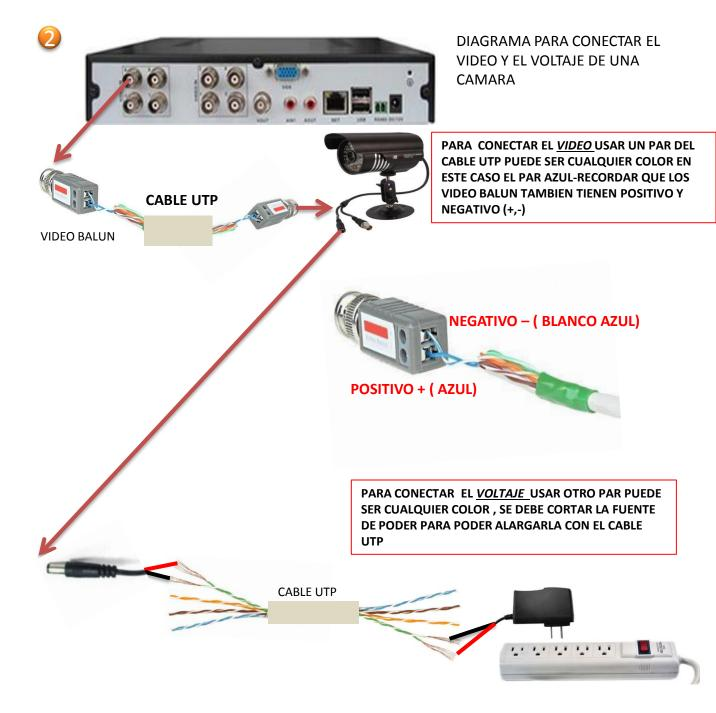
Para este caso usamos el par verde para cablear el voltaje, por el cable VERDE CONECTAMOS EL ROJO DE LA FUENTE QUE ES EL POSITIVO; Y CON EL CABLE BLANCO VERDE CONECTAMOS EL CABLE NEGRO DE LA FUENTE QUE ES EL NEGATIVO IMPORTANTE: EN LOS DOS EXTREMOS DEL CABLE UTP SE DEBE CONECTAR IGUAL, PARA EVITAR QUEMAR LA FUENTE O LA CAMARA
