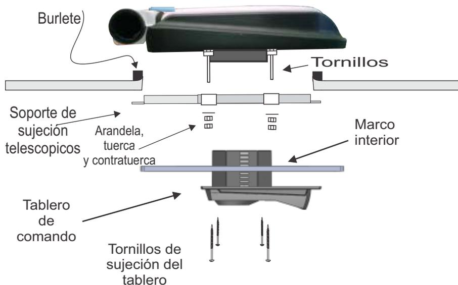
**Los 4 tornillos se ajustan en forma cruzada y pareja, hasta verificar que el burlete comienza a aplastarse con la base, impidiendo el paso de aire y agua del exterior.**
