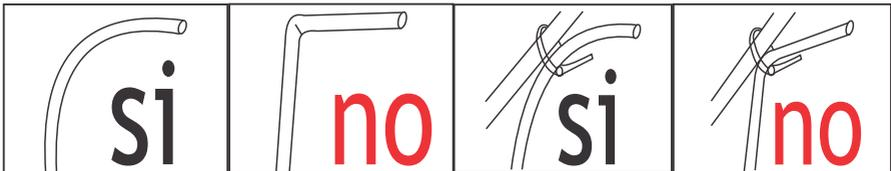
El climatizador NO debe ser instalado con inclinación negativa.
