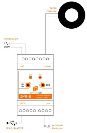
que une la bobina y el dispositivo tiene una medida predefinida por Servitec, <u>esta longitud no debe</u> <u>alargarse</u> porque cambiaría los resultados de las mediciones y estaríamos alterando las prestaciones del producto.
