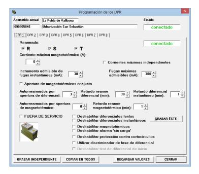
Los datos que se muestran son los del DPR que está señalado en la pantalla principal. Pulsando en la pestaña correspondiente se pueden ver y modificar los parámetros del resto de los DPR. A la vez que se pulsa la pestaña en esta ventana se cambian los datos de la pantalla principal automáticamente de forma que en las dos ventanas se tenga siempre el mismo DPR.
