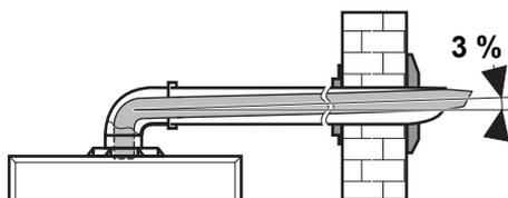
La ventosa horizontal de Saunier Duval da automáticamente un ángulo del 3° lo que permite el retorno de los condensados hacia el aparato.
