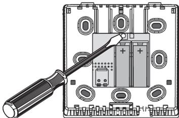
Presionar durante 10 seg. el botón satélite en la parte trasera de la caja de la sonda exterior. Para conectarse, la sonda manda señales - durante unos minutos - hasta que el termostato de ambiente la detecte y valide la conexión con la visualización :
