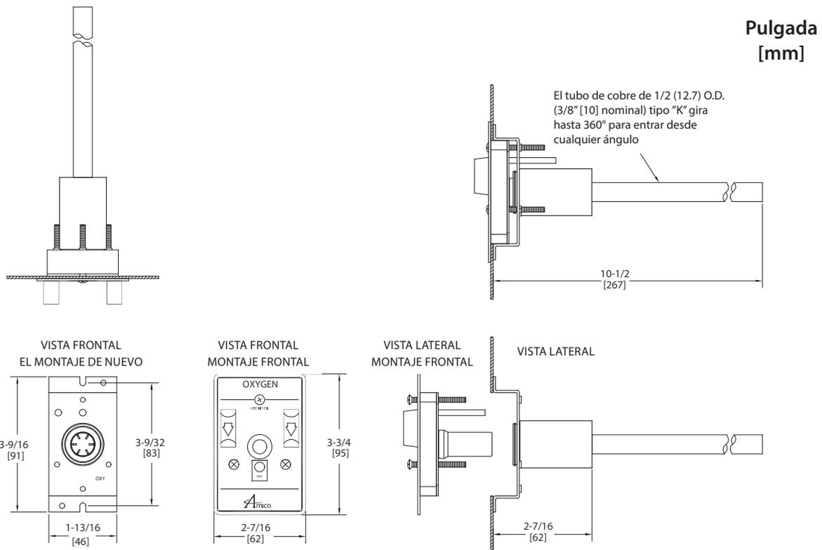
En todas las salidas (de pared y de consola), el tubo de conexión puede girar en 360° para una fácil conexión a la tubería de gas.
