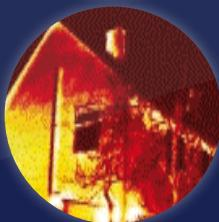
Foto tomada de una casa con lámparas de cultivo operando en la 1<sup>a</sup> planta sin C3 ADF.
