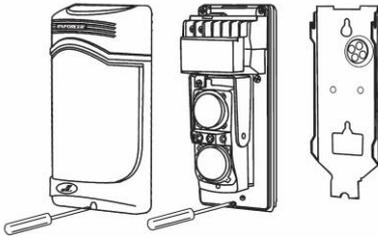
**Fig. 5: Montaje en pared, el alambre viene de la parte interna de la pared**
