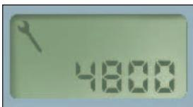
Cinco segundos después, es indicado el nivel de aceite; seguidamente el cuentakilómetros totalizador prosigue su funcionamiento normal y en el indicador aparecen los kilometrajes total y parcial.
