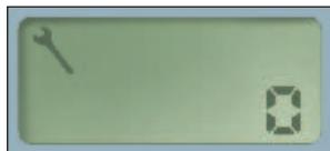
**Observación:** si el tiempo máximo entre dos vaciados fuera alcanzado antes del límite de kilometraje establecido, el símbolo de mantenimiento se enciende y el indicador señala «0» una vez rebasado dicho kilometraje.
