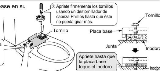
② Apriete firmemente los tornillos usando un destornillador de cabeza Phillips hasta que éste no pueda girar más.
