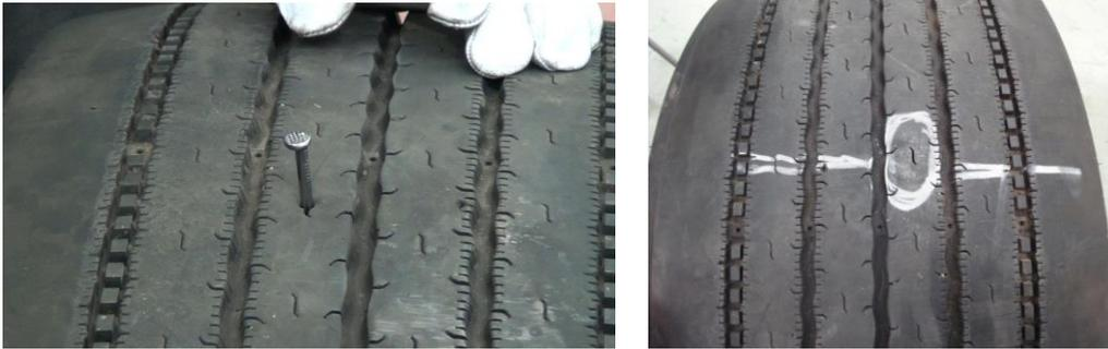
A continuación, se dosifica el producto **Blueshield49<sup>®</sup>** introduciéndolo por la válvula, previamente desmontado el obús, utilizando el equipo de dosificación para vehículo pesado.
