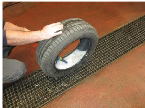
En la siguiente imagen se muestra el interior de la cubierta una vez secada en la zona del pinchazo.
