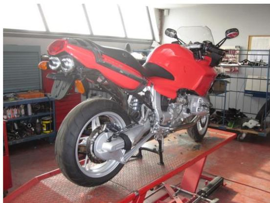
Después de observar que los neumáticos, en este caso los traseros, de las motocicletas no presentan ningún objeto incrustado o estén en mal estado, se aplica el producto **Blueshield49**<sup>®</sup> siguiendo las indicaciones del fabricante.
