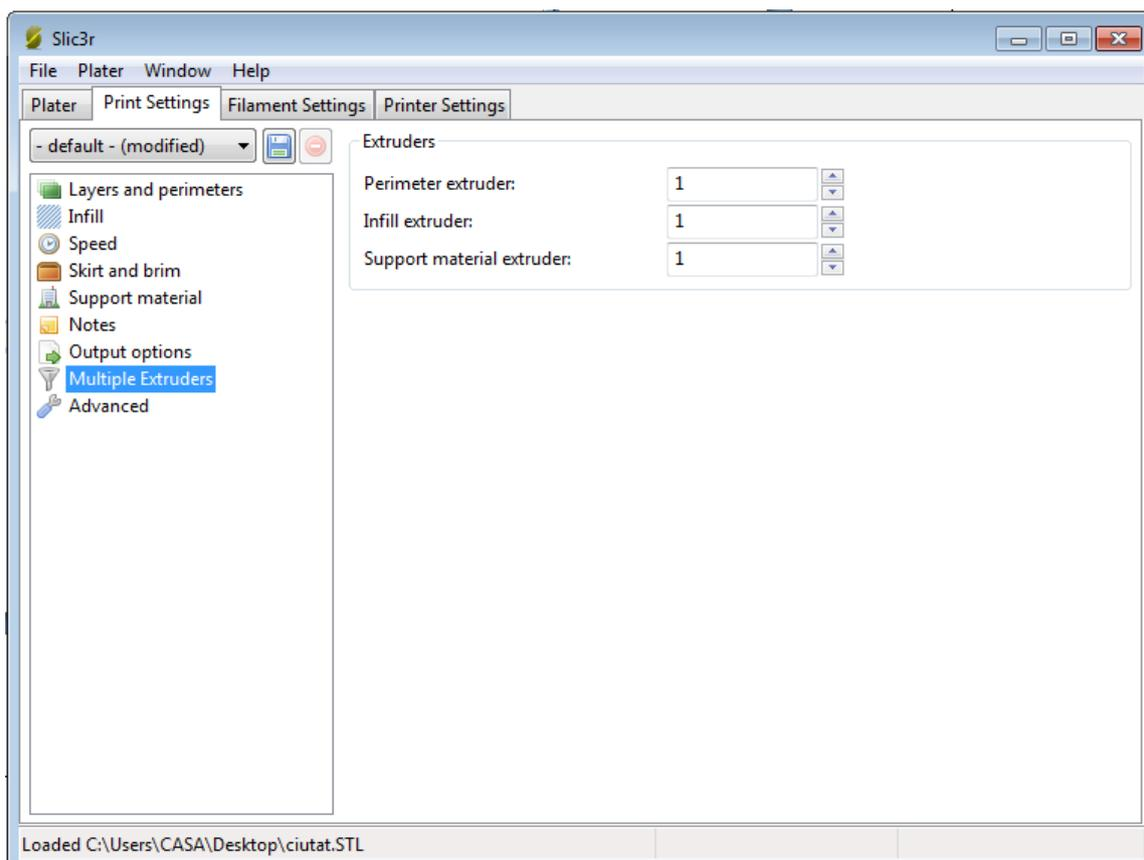
En este apartado se nos permite escoger cada extrusor (en caso de utilizar múltiples cabezales) hará cada parte de la pieza.
