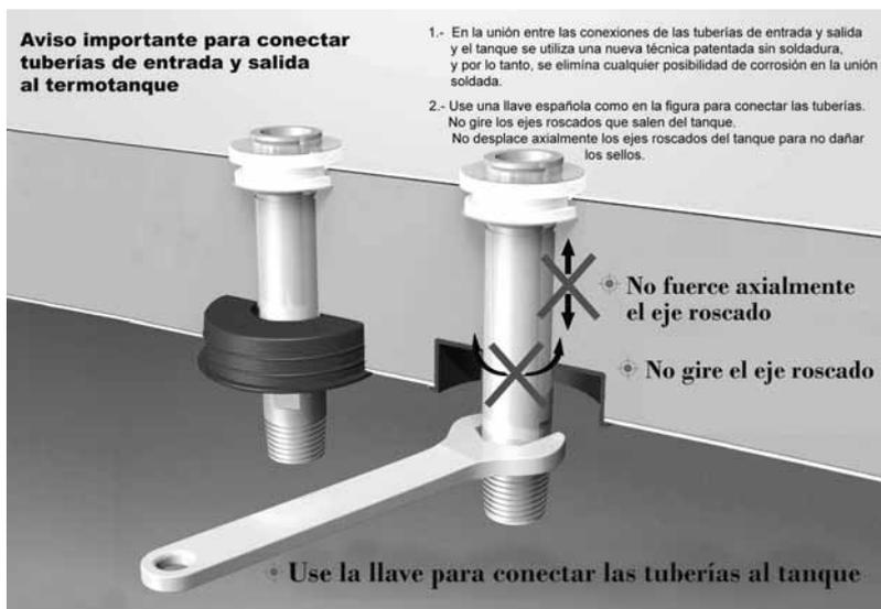
En este caso se debe poner especial cuidado en la instalación del jarro de aire, pues las conexiones pueden girar libremente y el jarro de aire podría caer, dejando de funcionar adecuadamente y se vaciará el tinaco.
