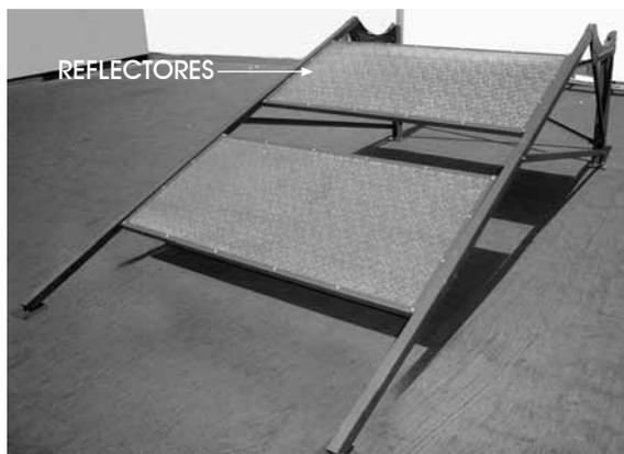
Terminado el ensamble de la estructura, se instalarán los reflectores (en los modelos que los incluyan) recomendándose instalar primero el reflector inferior y después el superior; use tornillos tipo A.
