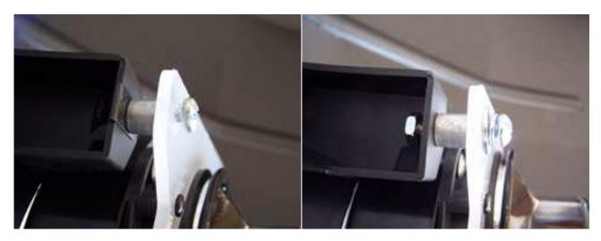
Una vez instalados sus faros, ajuste el haz de luz con el ajustador de luz que queda en la parte inferior del faro, hágalo de a poco, pues de hacer un ajuste muy pronunciado puede desarmar el ajustador.
