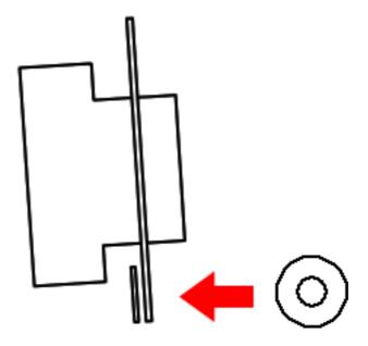
Si el ajuste, requiere que el haz de luz sea hacía arriba, entonces deberá poner 2 arandelas, una entre cada soporte superior de la facia, como se muestra en la siguiente imagen.
