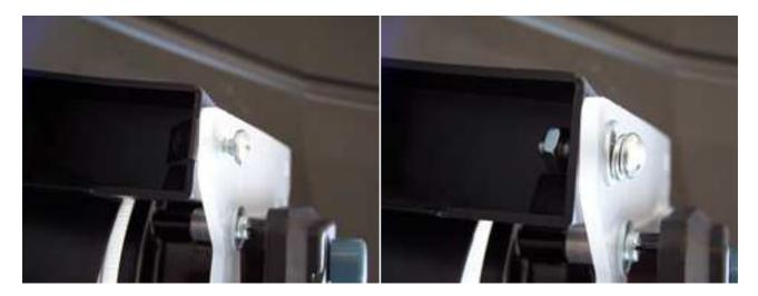
Este modelo de faro no incluye ajustador de haz de luz, por lo que para ajustar el haz de luz hacia abajo, se hace poniendo una arandela (rondana) entre el soporte de la facia y la base del faro donde va el tornillo inferior, como se muestra en la siguiente imagen.
