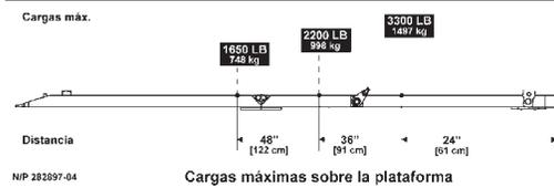
**Etiqueta de colocación de carga (sólo modelo DMD-33)**
