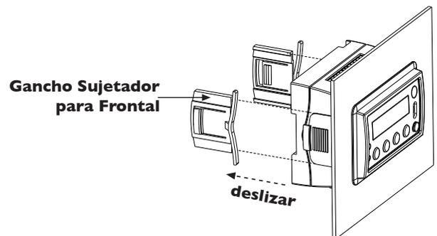
b) Remueva el Frontal Insertable (**Flush Mounting**) y el **GII+** como se muestra en la siguiente figura:
