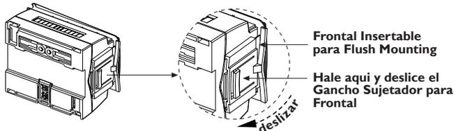
c) Inserte el Frontal del **GII+** en el panel, tal como se muestra en la figura:
