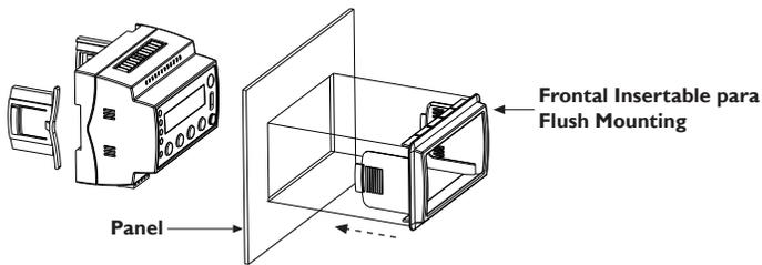
d) Coloque el **GII+** desde la parte posterior y use los Ganchos Sujetadores para Frontal para fijar el **GII+**, hasta que haga CLICK, tal como se muestra en la siguiente figura:
