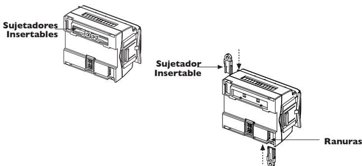
b) Coloque el **GII+** sobre la superficie plana del panel y fíjelo usando tornillos 3/16 x 1/2 pulgadas, empleando un destornillador o desarmador adecuado.
