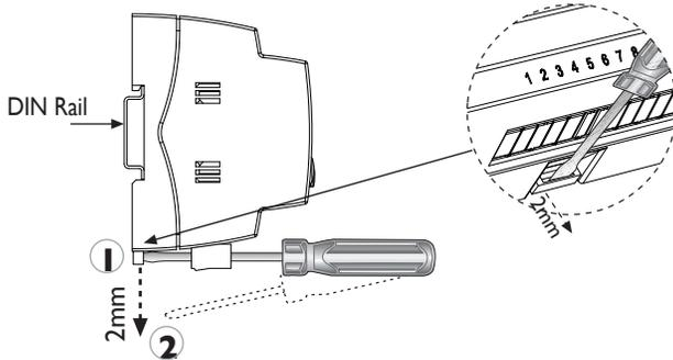
b) Mediante el destornillador o desarmador desplace el gancho a la posición (2), saque el **GII+** del Riel Simétrico, tal como se ve en la figura.
