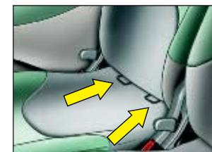
La instalación defectuosa de un asiento de niño en un vehículo compromete la protección del niño en caso de colisión. El sistema ISOFIX permite limitar posibles riesgos de una mala instalación. Este sistema de fijación ISOFIX garantiza un montaje fiable, sólido y rápido de un asiento de niño en su vehículo.
