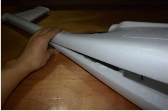
PASO 14: Instalación del timón: insertar la varilla de mando en el prisionero y dar pegamento al timón; a continuación, fijar la varilla de mando con el tornillo. Cortar varilla sobrante.
