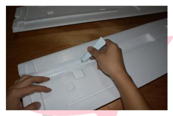
PASO 4: Esperar alrededor de 1~2 minutos a que se solidifique ligeramente el pegamento, antes de poner las dos cubiertas del tubo de carbono.
