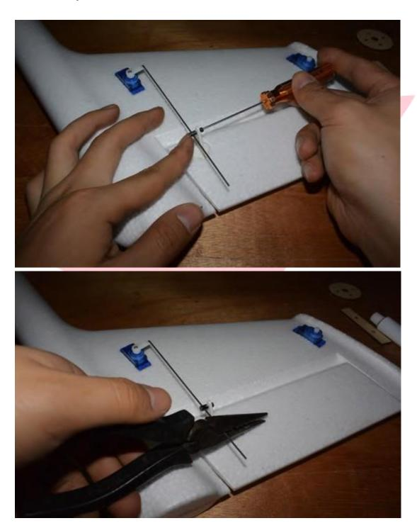
PASO 15: Instalación de la cola horizontal: pegar el chip de madera y cortar con una brecha de 1 mm a ambos lados del timón de profundidad.
