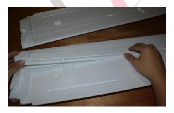
**PASO 5:** Insertar el tubo de carbono, poner el pegamento en la ranura del tubo de carbono y presionar suavemente el tubo de carbono hacia la ranura. Esperar 2 minutos y volver a presionar para fijar.
