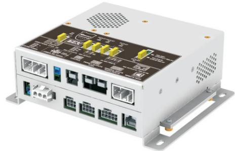
Denominamos Sirena Remota a un sistema integrado de control de luces, sirenas, otros periféricos y funciones específicas del vehículo, compuesto por un dispositivo de control remoto (RSC4000), una unidad central de procesamiento (CPU), un cable de transmisión de datos, un micrófono, y el kit para fijación de todos estos dispositivos.
