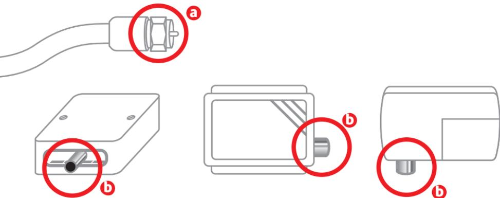
Enrosca una **punta del cable (a)** en la **toma (b)** y conecta la otra **al equipo**.
