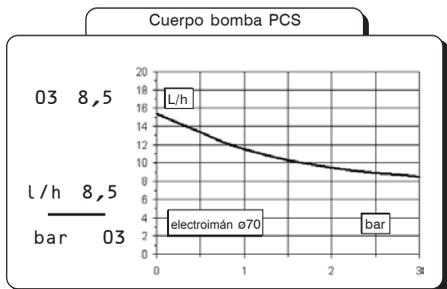
Todas las indicaciones de capacidad se refieren a medidas efectuadas con H<sub>2</sub>O a 20°C y a la contropresión indicada. La precisión de dosificación es del ± 2% y a una presión constante de ± 0,5 bar.
