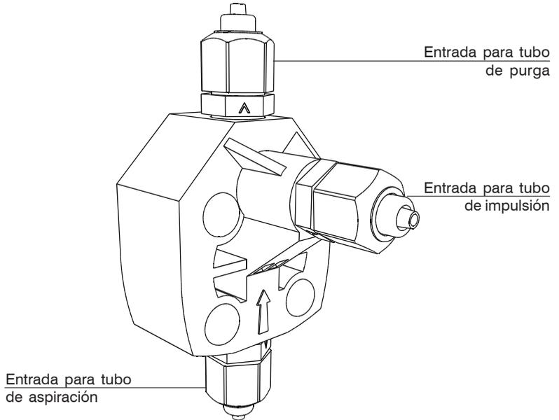
El uso de una bomba con cabezal autopurgante es necesario para la dosificación de productos químicos que generen gas (ej.: peróxido de hidrógeno, amoníaco, hipoclorito de sodio a determinada temperatura).
