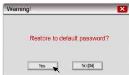
En caso de que el usuario pierda u olvide las contraseñas del sistema, debe colocar el conmutador DIP 1 en la posición ON, manteniendo el resto en posición OFF y a continuación, reiniciar el MT-8000 / MT-6000. En este caso, pasará al modo de ajuste (modo para calibrar la pantalla táctil). Después de calibrarla, aparecerá la ventana que se muestra al lado. Se le preguntará al usuario si quiere restablecer la contraseña por defecto.
