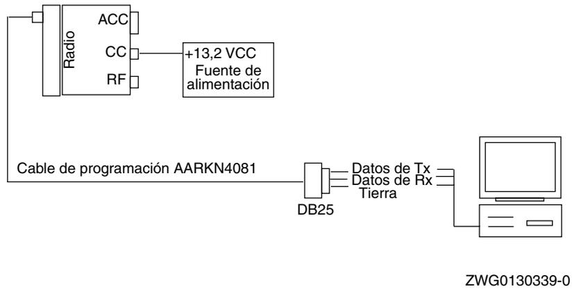
**Figura 4-2** Cable de configuración del CPS con RIB interna
