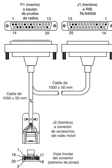
Figura 2-1 Cable de programación/prueba AARKN4083\_
