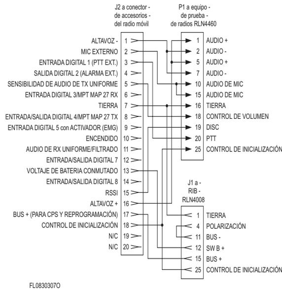
Figura 2-2 Configuración de los pines del conector lateral del cable
