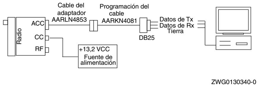
**Figura 4-3** Cable de configuración de la programación del CPS con RIB interna y cable del adaptador de la parte posterior
