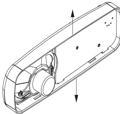
**Figura 2-7** Retiro de la tarjeta del cabezal de control
