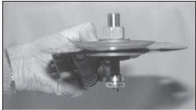
El sub-ensamble parcial del diafragma consta de: (10), (11), (12), (13), (15), (16), y (20). (Diseño de diafragma metálico).
