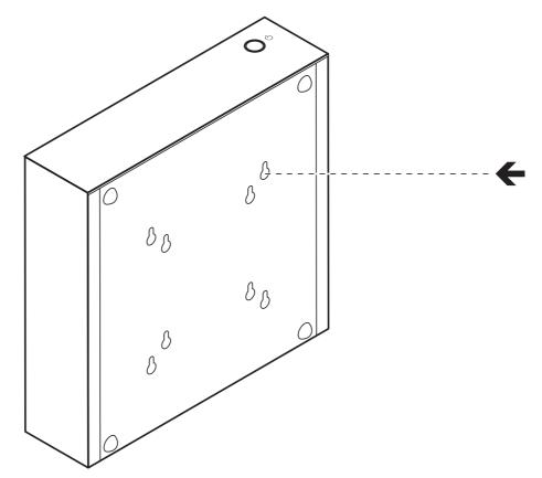
Puede montar el descodificador VIP XD HD en un monitor aprobado. Para ello, utilice el kit de montaje suministrado.
