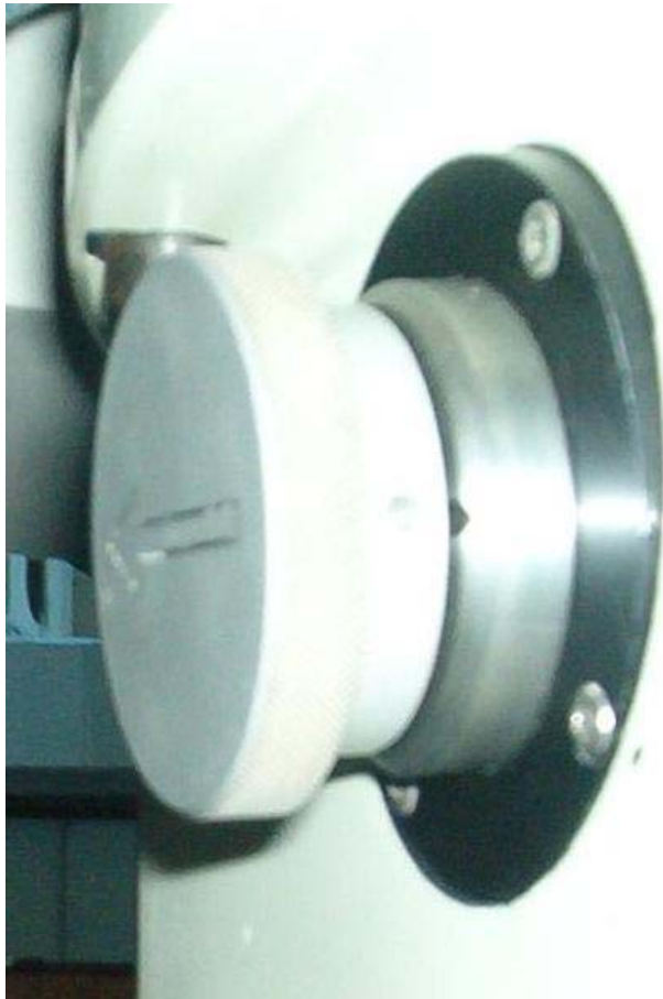
Figura 7. Selección de la lámpara de comparación, en posición dentro y apuntando a la lámpara de comparación.
