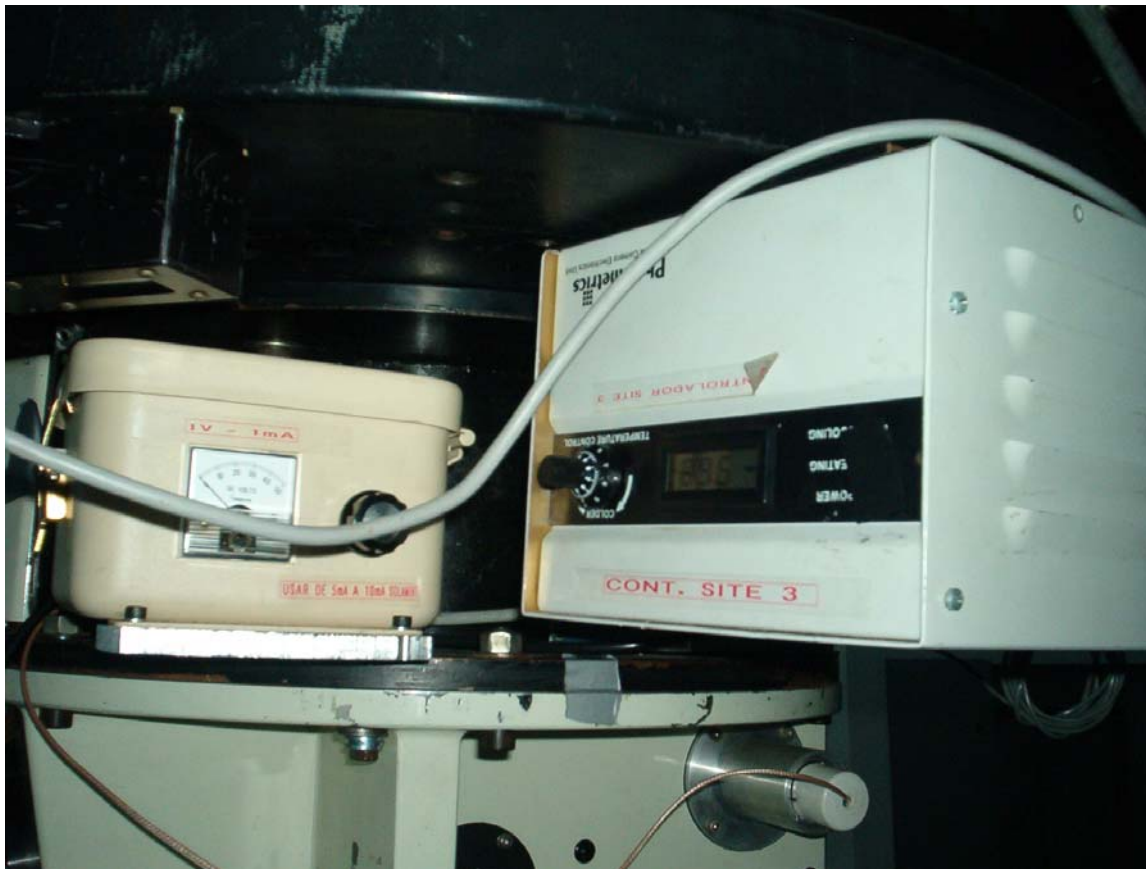
Figura 2. Fuente de alto voltaje y controlador Photometrics de CCD's.
