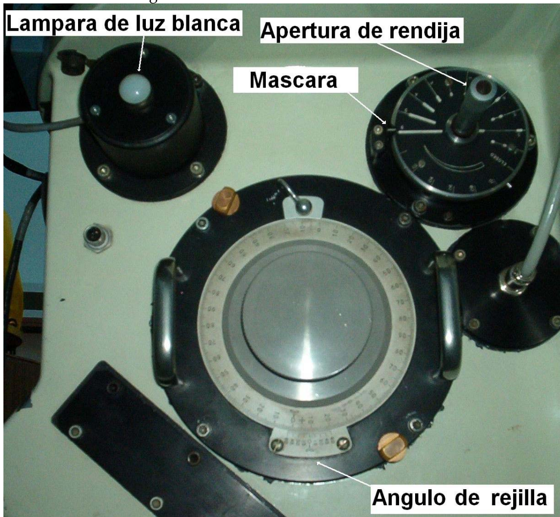
Figura 6. Lado este del espectrógrafo, ajuste de mascara, apertura de rendija y ajuste de ángulo de rejilla.
