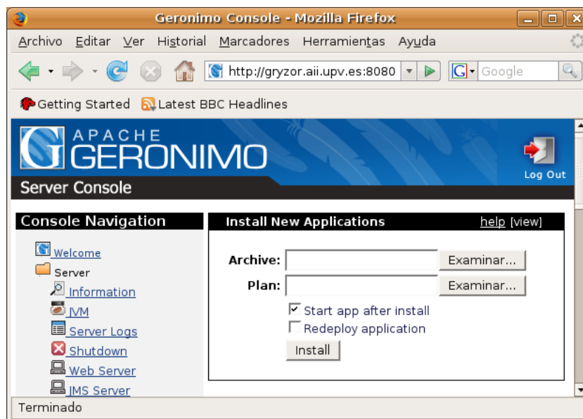
Figura 5.5. Pantalla de despliegue de aplicaciones web
