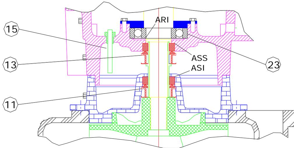
Fig. 3. ↑ Esquema del sistema de protección constituido por dos sellos mecánicos.
