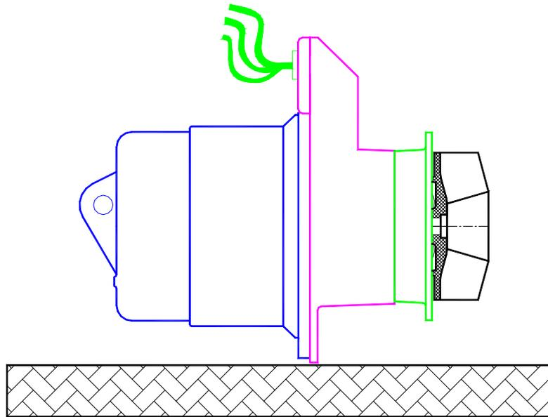
retirar la carcaza y colocar nueva y lentamente la bomba sobre la paleta en posición horizontal, ver la Fig. 10.
