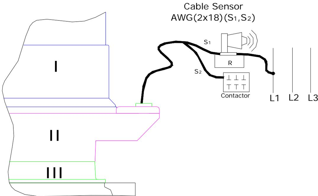
conductores (AWG 2x18), ver la Fig.8 . En caso de ingreso de líquido a la cámara de los sellos, se activara la señal de alarma, la cual perdurará hasta que se realice la respectiva rutina de mantenimiento, sin embargo, el usuario puede continuar operando la bomba por corto tiempo.
