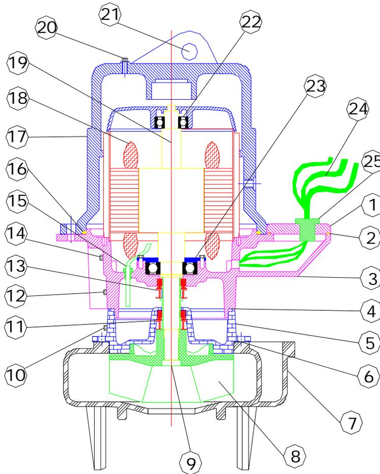
Fig. 2 ↑Partes principales de la bomba.
