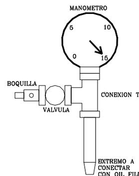
Fig. 5 → Esquema del dispositivo de inyección y medición de la presión de aire de la prueba neumática.
