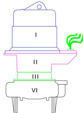
FIG. 1 ↑ Elementos principales de una bomba ROBUSTA accionada con un motor FRAME 180.
