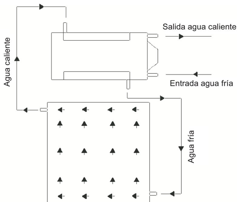
Un circuito cerrado donde el fluido caloportador del captador pasa a la capa exterior del interacumulador y una vez efectuado el intercambio de calor vuelve al captador para ser recalentada. Simultáneamente, el agua fría de la red entra al interacumulador, se calienta y pasa directamente al consumo.
