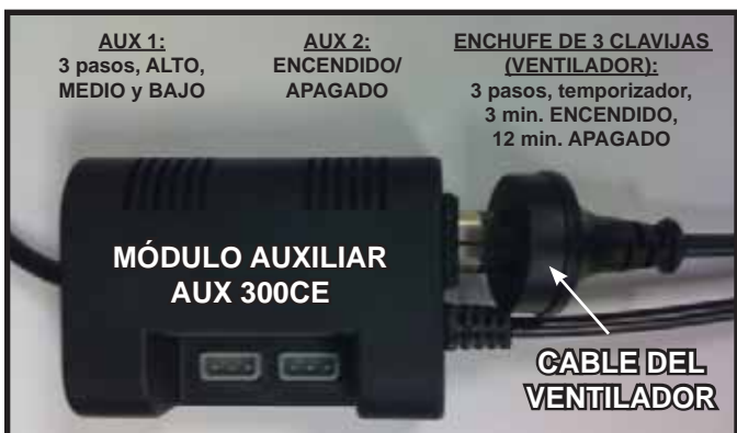
Figura 12.9 Enchufe el ventilador en el módulo AUX300CE
