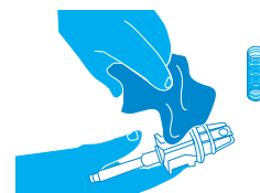
Limpieza de válvula
