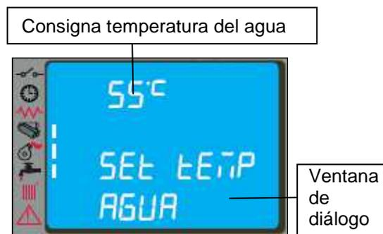
Cuando la temperatura del agua alcanza el punto de consigna, incluso simultáneamente a la situación descrita en el apartado 4.4.1, la potencia se reduce automáticamente al mínimo, en estado de **MODULACIÓN**.
