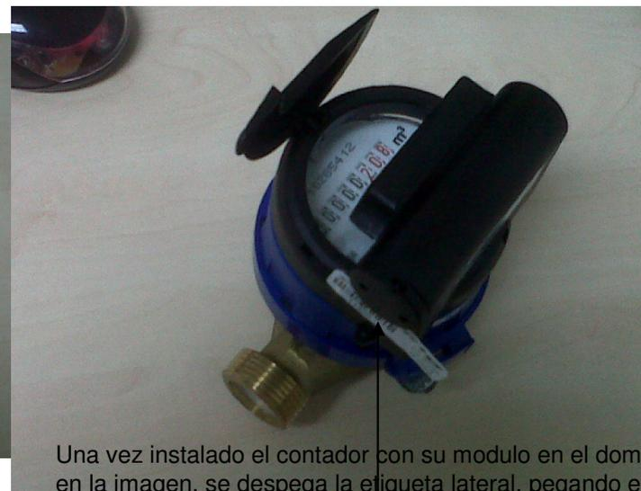
Una vez instalado el contador con su modulo en el domicilio, tal y como se ve en la imagen, se despega la etiqueta lateral, pegando esta en el parte de trabajo, junto con el numero de contador y dirección, numero y titular. Estos datos serán incorporados posteriormente a la base da datos de lecturas y de gestión del Ayto.
