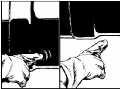
17-Durante la termocontracción, verifique con el dedo con guante, si el adhesivo fluyó. Las arrugas desaparecerán automáticamente.
