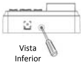
**1.1.** Con el desarmador o llave de punta torx incluida, remueva el tornillo de seguridad de la parte inferior.
