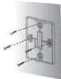
**1.3.** Instale los taquetes de plástico incluidos en la pared y atornille la cubierta trasera.
