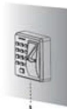
**1.5.** Tense el tornillo de seguridad de la parte inferior.
