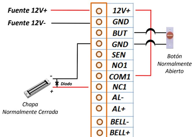
**Conexión de chapa con circuito normalmente abierto:**
