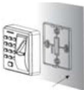
**1.4.** Coloque el lector en la cubierta trasera.
