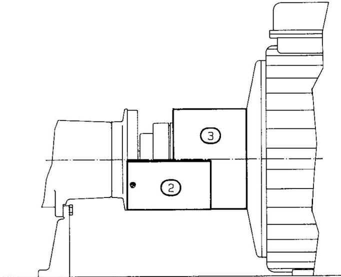
6. Extraiga los tornillos (4) que conectan la mitad superior (parte 2) del protector de acoplamiento a la cubierta del cojinete (1).
