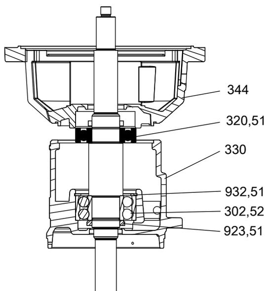
j) Extraiga el pasador que se utilizó para alinear el adaptador del bastidor y el bastidor. Una el bastidor del cojinete (330) al adaptador del bastidor (334) con los pernos hexagonales (901,41).
