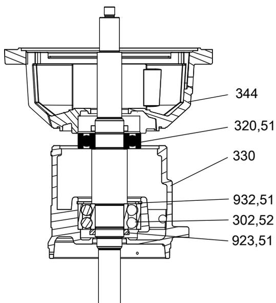
4. Extiéndase dentro del bastidor y extraiga el anillo de elevación (932,51) utilizando las palancas del anillo de elevación designadas.
