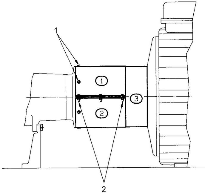
5. Conecte ambas mitades (partes 1 y 2) del protector de acoplamiento utilizando tornillos (2). Esta acción también asegura la pieza de ajuste (parte 3).
