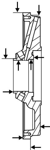
**Cifra 15: Cubierta de la caja de empaquetadura**
