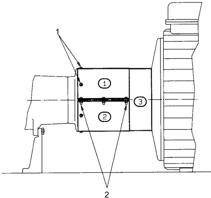
3. Extraiga los tornillos (1) que conectan la mitad superior (parte 1) del protector de acoplamiento a la cubierta del cojinete.
