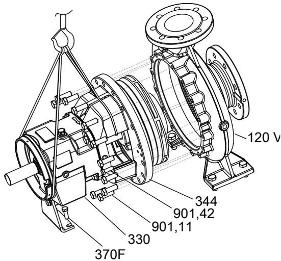
3. Instale y ajuste a mano los pernos de la carcasa (901,11).
