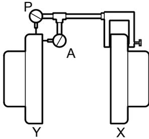
2. Gire la mitad del acoplamiento de la bomba (X) para controlar que los indicadores estén en contacto con la mitad del acoplamiento del motor (Y) y que no toquen la parte inferior.
