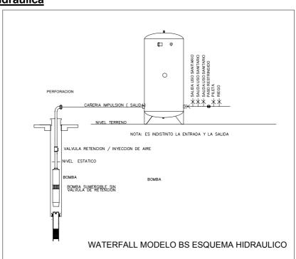
El sistema hidráulico propuesto permite una fácil operación sin complicadas maniobras para utilizar el riego y la pileta.
