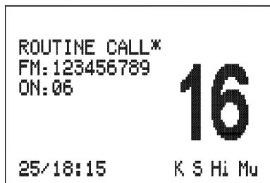
Pulsar **(ENT)** en el micro , una respuesta automática se enviará al emisor. La Radio automáticamente cambiará a modo de comunicación de voz normal . La señal “\*” desaparecerá cuando se reconozca la llamada.
