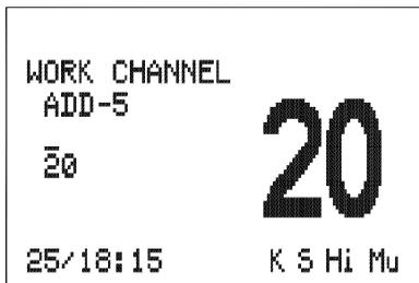
Pulsar ▲ o ▼ para cambiar el canal seleccionado, pulsar (ENT) para aceptar. pulsar ◀ o ▶ para seleccionar el siguiente canal. Para borrar un canal de trabajo , pulsar ◀ o ▶ para seleccionarlo seleccionar "DEL", pulsar (ENT) para aceptar.
