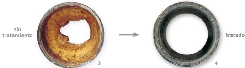
Vulcan impide la formación de nuevas incrustaciones en el tubo. El proceso natural de remoción del sarro solamente tiene que eliminar sedimentos ya existentes. El sarro se reduce rápidamente antes de volverse a formar. El tubo queda libre de incrustaciones (fig. 4). El ácido carbónico sólo puede disolver el sarro y no el sarro de las paredes internas de los tubos; así permanece una fina capa protectora en los tubos.
