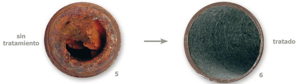
La técnica de impulsos de Vulcan, con su efecto electroforesico, fomenta la formación de una capa metálica protectora de cobre. Esta capa se compone, conforme al material del tubo, de carbonato de cobre, hierro o zinc que se puede encontrar en las superficies relucientes de metal; de esta forma Vulcan protege así toda la tubería del óxido y la corrosión.
