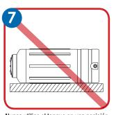
Nunca utilice el tanque en una posición distinta para la cual se ha diseñado.
