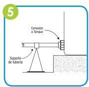
Sujete la tubería de agua con un soporte cerca de la conexión con el tanque (30 - 50 cm). Esto disminuirá la presión en la pared del tanque ejercida por cualquier movimiento de la tubería, sobre todo cuando se instala una bomba.
