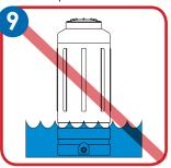
No coloque el tanque en un terreno donde existan corrientes superficiales de agua o en terrenos propensos a inundarse.
