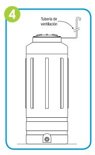
Cuando conecte al tanque un sistema de bombeo es necesaria la instalación de una tubería de ventilación en la parte superior del tanque. La tubería no debe tener menos de 38mm (1½ ") de diámetro.
