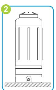
Coloque el tanque en posición vertical sobre una superficie totalmente lisa, nivelada y libre de objetos que pudieran dañar el fondo del tanque. Se recomienda colocar el tanque sobre una losa de concreto.
