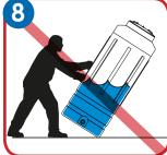
No manipule el tanque estando lleno, o parcialmente lleno, de agua.
