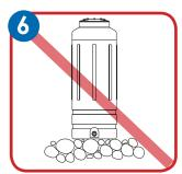
No coloque el tanque sobre piedra triturada, vegetación, raíces o elementos que puedan, de algún modo, dañar el fondo del tanque
