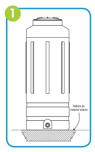
Si va a colocar el tanque en el exterior, asegúrese que el terreno donde instale el tanque sea firme y compacto. Si el terreno es muy blando o es un relleno, sustituya con material selecto compactando parte del terreno debajo de donde se ubique el tanque. Consulte con un ingeniero sobre más detalles.
