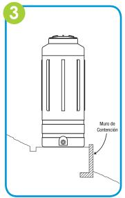
Cuando se localice el tanque sobre una pendiente se debe tomar medidas para realizar una correcta contención del terreno y una canalización adecuada del agua llovida.
